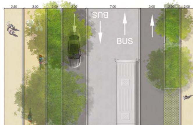
L'insertion du du BHNS/TB12 sur la route de Genas
